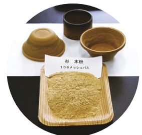
新素材「ニュー・ウッド・マテリアル」の成型品(写真上)とその原料(写真下)
